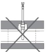
Die Verschraubung der Temperaturfühler darf auf keinen Fall mit isoliert werden. Dies gilt auch, wenn der Temperaturfühler direkt im Durchflusssensor montiert ist.
