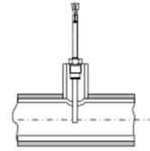
Temperaturfühler senkrecht zur Rohrachse
