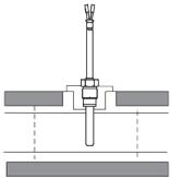
Die Isolation darf nur bis zur Temperaturfühlerschraubung vorgenommen werden.
