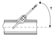
Temperaturfühlermess-element eingetaucht in die Rohrachse
