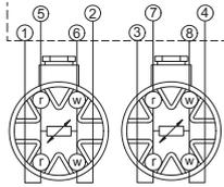
Kabelquerschnitte für Kopffühler  $\geq 0,5 \text{ mm}^2$  (EN 1434-2)
