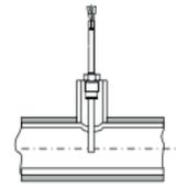
Temperaturfühler senkrecht zur Rohrachse
