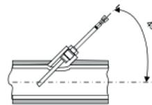
Temperaturfühlermess-element eingetaucht in die Rohrachse
