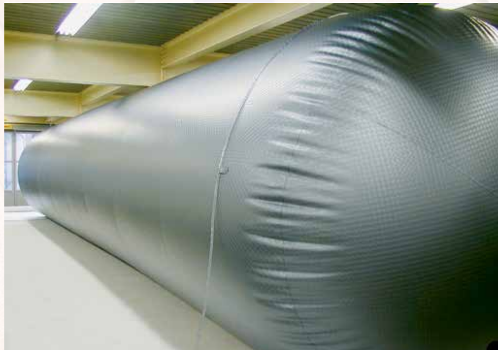
Die Tank-Innenhülle wird vorab getestet.
