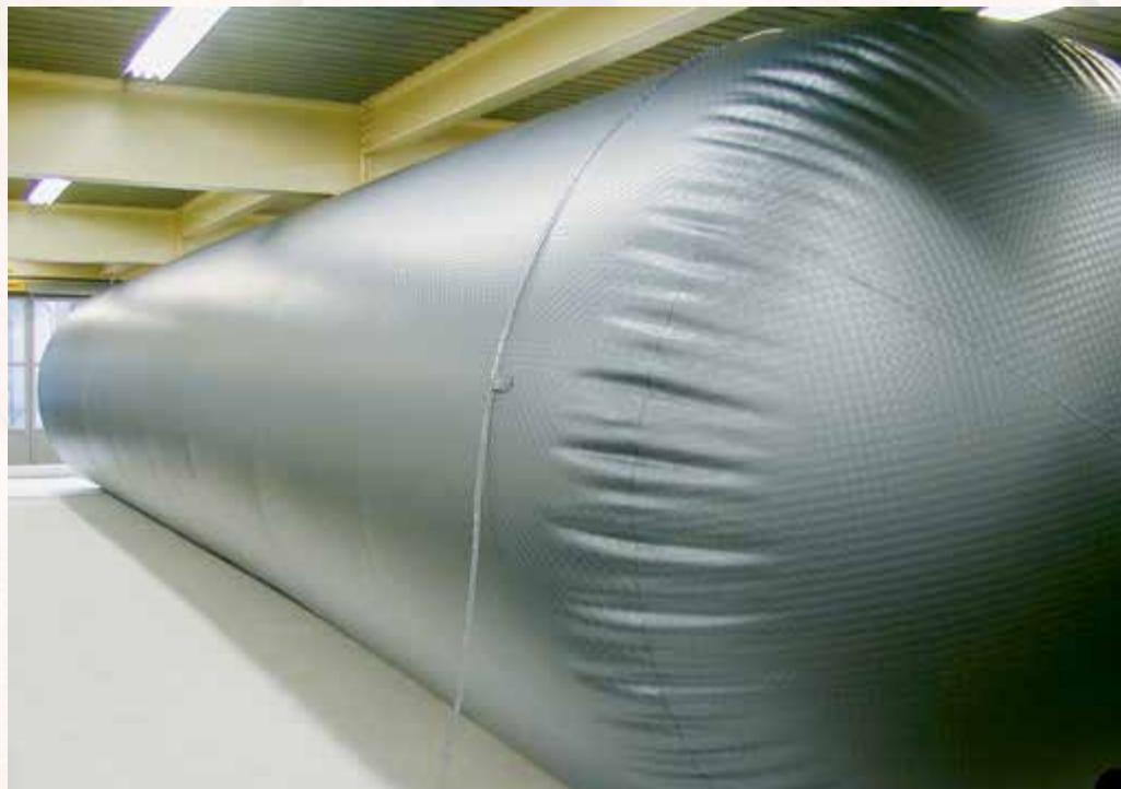
L'enveloppe est d'abord testée en usine.
