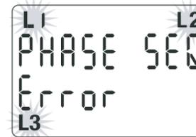
Die Reihenfolge der Verkabelung (L1-L2-L3) ist falsch. L1-, L2- und L3-Symbole blinken. Tauschen Sie die Adern von 2 Phasen (Phase 1 < > Phase 2 oder Phase 2 < > Phase 3). Andernfalls wird die Nachricht durch Drücken der "OK" -Taste für mindestens 5 Sekunden bis zum nächsten Neustart gelöscht.
