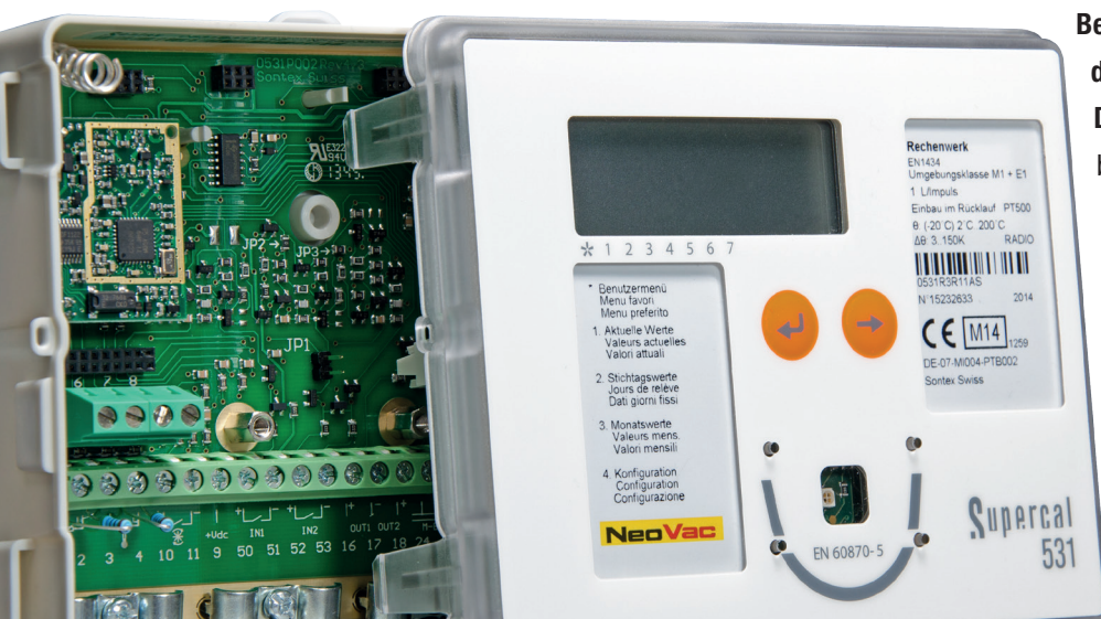
Das Rechenwerkunterteil für Anschlüsse, Speicher, Speisung und Kommunikation
